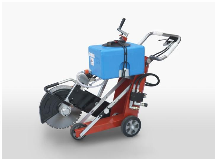
**SC40** è un accessorio che trasforma le seghe idrauliche manuali **DC14 - DC16** in un pratico carrello taglia asfalto, la sega si monta sul carrello in pochi secondi senza fastidiose regolazioni o collegare cavetti ecc, il collegamento idraulico avviene semplicemente con due innesti rapidi. Non come altri simili carrelli, **SC40** ha una propria valvola idraulica di partenza che semplifica l'installazione, il montaggio meccanico avviene per mezzo di due vite ed il carrello è pronto all'uso.
